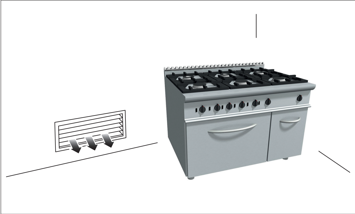
Abb. 25 Belüftung des Installationsraums
