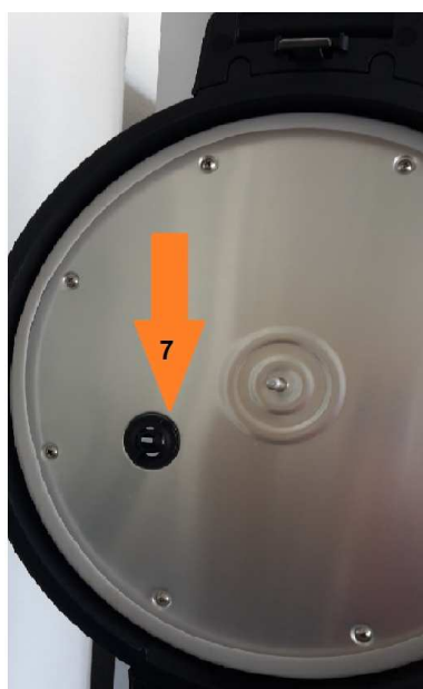
Salida de vapor (7) Debajo de la cubierta después De quitar la cubierta interior de la tapa
