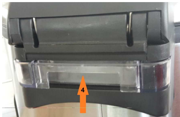
Bisagra insertada, bandeja De agua condensada transparente (4)
