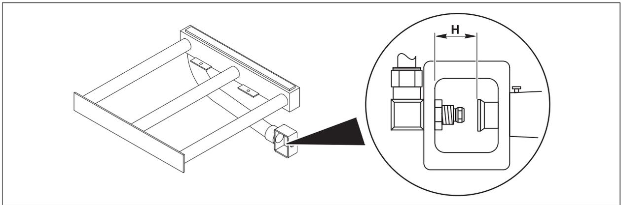
Abb. 17 Einstellung Primärluft Gasbrenner
