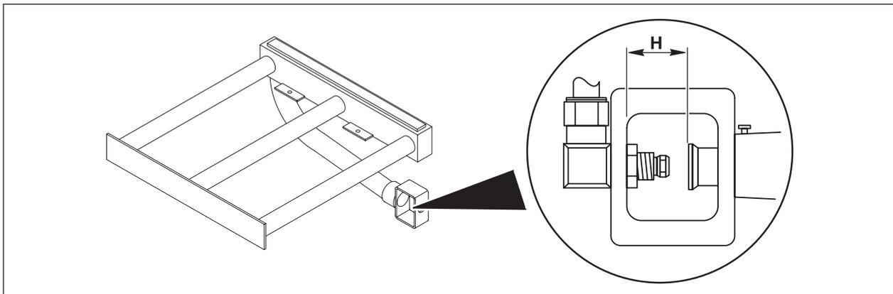
Abb. 16 Einstellung Primärluft Gasbrenner
