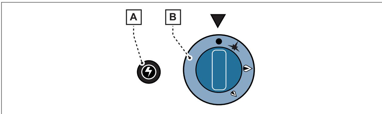
Abb. 5 Darstellung der Schalteinrichtungen der Modelle mit Platte aus weichem Stahl
